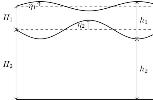
Figure 2.3: Modèle à gravité réduite. Les traits en pointillés sont la position des interfaces au repos. L'épaisseur des couches au repos est  $H_1$  et  $H_2$  pour la couche du haut et du bas respectivement. Les anomalies de hauteur de l'interface sont  $\eta_1$  et  $\eta_2$ .
