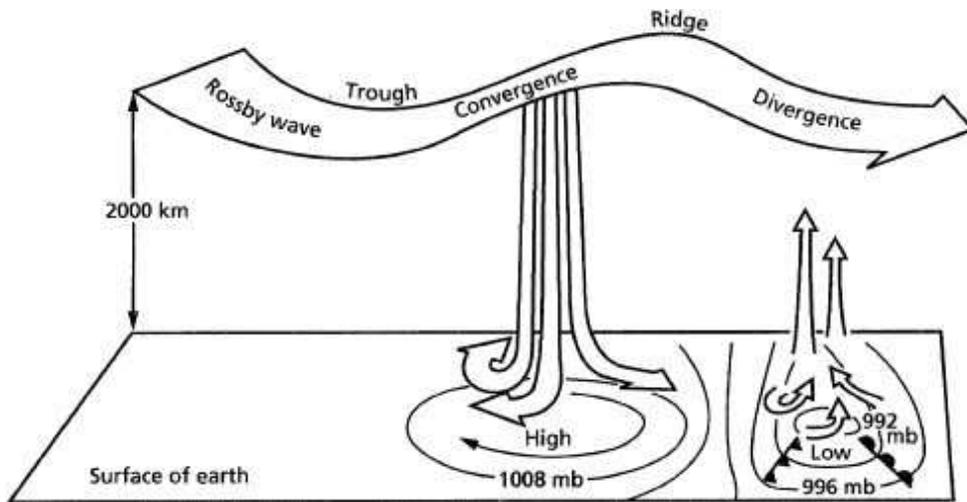
Figure 1 : représentation schématique du développement des perturbations atmosphériques par interaction du courant-jet avec des structures de basses couches.
